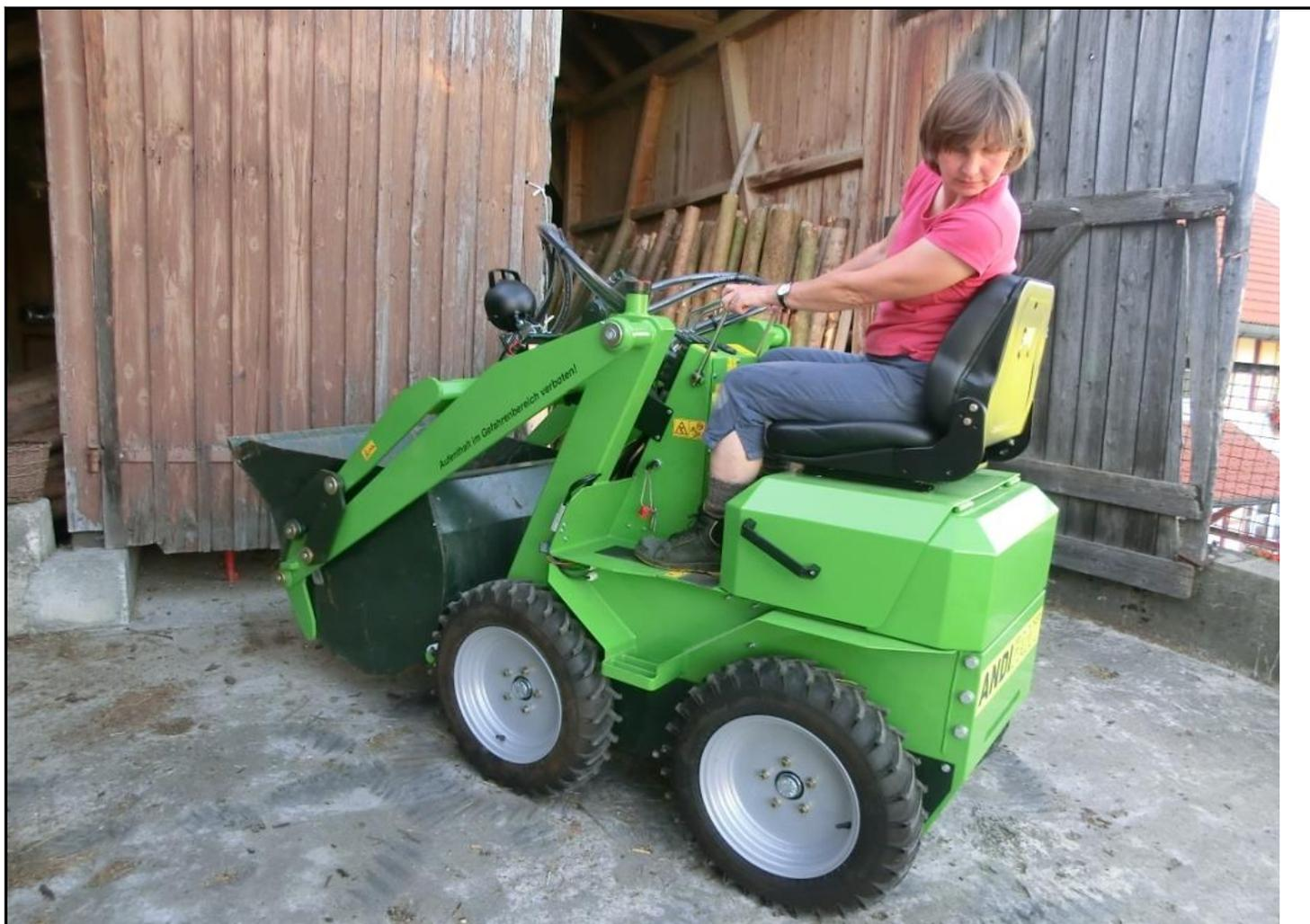
Der Typ AF-P hat das Hydrauliköl links u. rechts in den Holmen, die Hydraulikhebel in der Mitte vom Bedienturm
